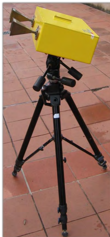
Caratterizzazione dinamica delle torri con radar interferometrico
